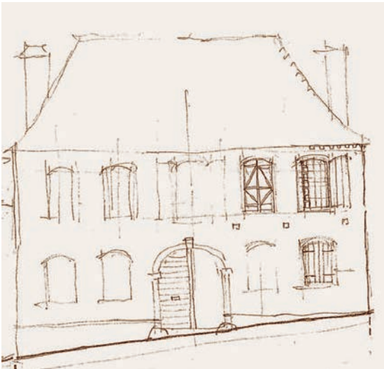
Type de grande maison sur regroupement de parcelles anciennes (deux trames) – faitage parallèle à la rue, avec croupes de chaque côté, cinq travées avec portail dans l'axe de symétrie – pas de lucarne. 1752 – rue Moncade
