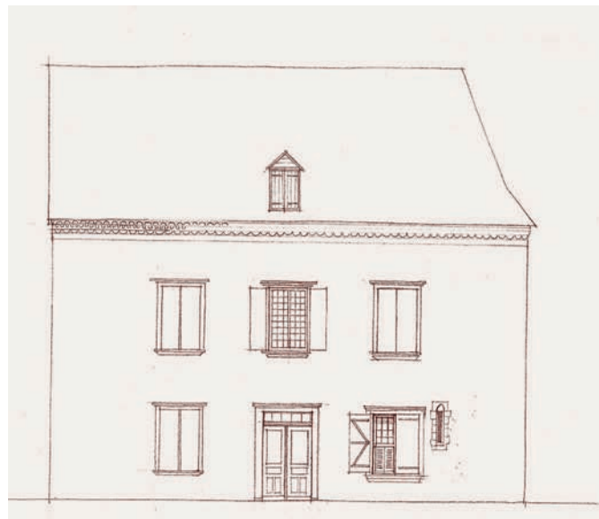
Type de maison sur parcelle ancienne incluant une structure ancienne – recomposition complète faîtage parallèle à la rue – croupe d'un côté et pignon mitoyen de l'autre., trois travées avec porte et lucarne dans l'axe de symétrie. Rue des Aiguilletiers
